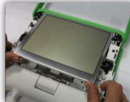
Retire la pantalla LCD con mucho cuidado, levante de la parte inferior y jale hacia atrás. No levante toda la pantalla porque está sujeta con dos cables en la parte posterior.
