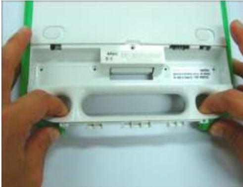
Después de retirar los tornillos, voltee la laptop e introduzca los dedos índices en los orificios extremos de la base. Tal como se muestra en la imagen.
