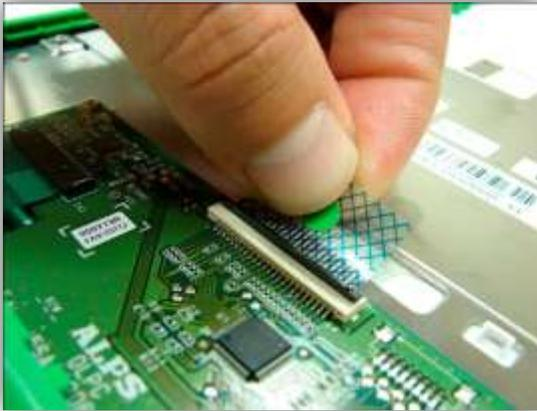
Para desconectar el cable del teclado necesita levantar el protector negro hacia arriba y jalar con mucho cuidado el plástico conector.
