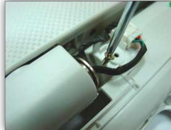
La imagen muestra la forma de retirar los tornillos. Luego desconecte el conector que se muestra.
