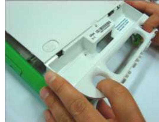
Levante un poco y jale hacia atrás. Con este procedimiento desmontará la tapa posterior del equipo.
