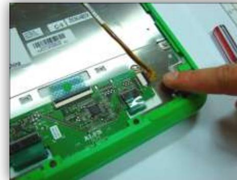
Desconecte el cable de colores que viene de la placa madre al controlador del teclado y mouse.
