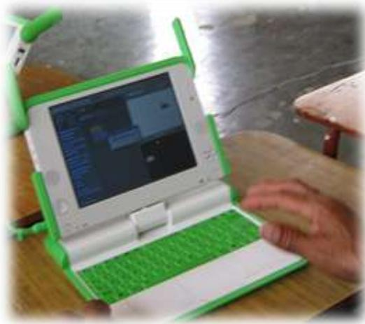
El software del sistema por defecto para la computadora portátil XO incluye amigables Actividades para niños, tiene una interfaz de usuario llamada Azúcar, y muchos otros componentes de software construido sobre una versión modificada del núcleo de Linux Fedora.<sup>1</sup>
