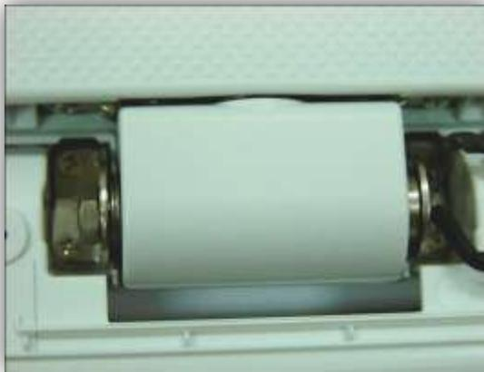
Retire los cuatro tornillos que sujetan el pivote, esto le permitirá retirar la base donde se encuentra el teclado.
