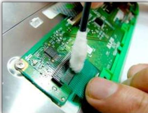
Repetir estos pasos con los demás conectores de la membrana del mouse. Volver a conectar los cables del teclado y armar el equipo, siguiendo los mismos pasos vistos hasta aquí.
