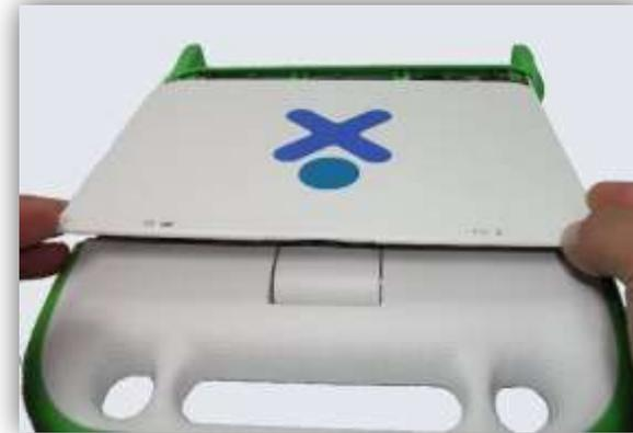
Gire la parte superior y retire la tapa posterior levantando un poco y jalando hacia atrás, tal como se muestra en la imagen.
