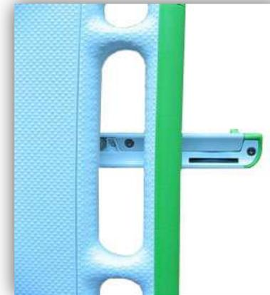
Para comenzar a desarmar la parte del monitor abra la laptop XO de tal manera que quede en un ángulo de 90° y pueda girar el monitor hacia ambos lados (derecha e izquierda) y así retirar los cuatro tornillos que se encuentran en la parte inferior.
