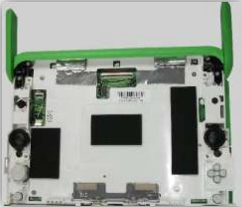
Continuando con el desarmado del equipo, retire los cuatro tornillos que se muestran en la imagen.
