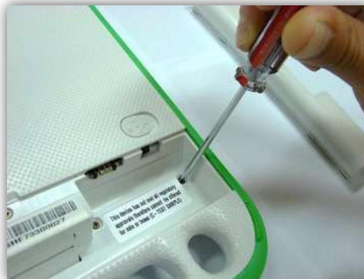
Se necesita un destornillador tipo estrella número 102 o 3/16. Extraer los cinco tornillos que se encuentran en la cavidad de la batería
