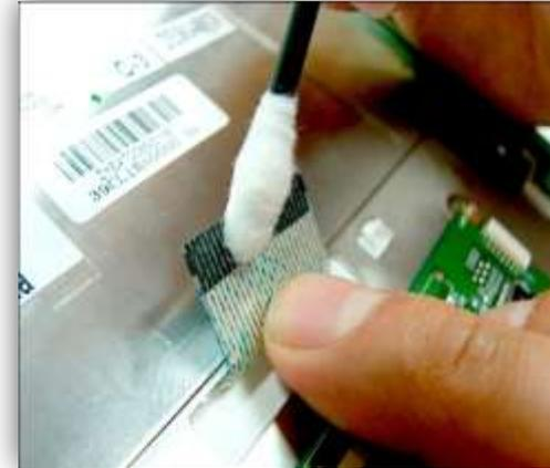
La limpieza de los contactos debe realizarse con **alcohol isopropílico** y un paño de algodón, por ambas caras del cable de plástico.
