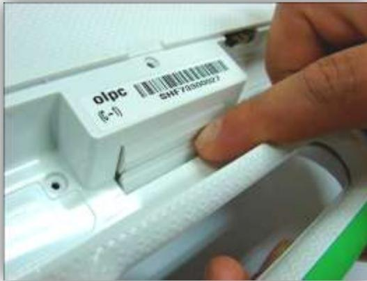
Empuje con la yema del dedo la ranura ubicada en el centro de la cavidad de la batería. Al presionar se retira la tapa que se encuentra al costado del asa.
