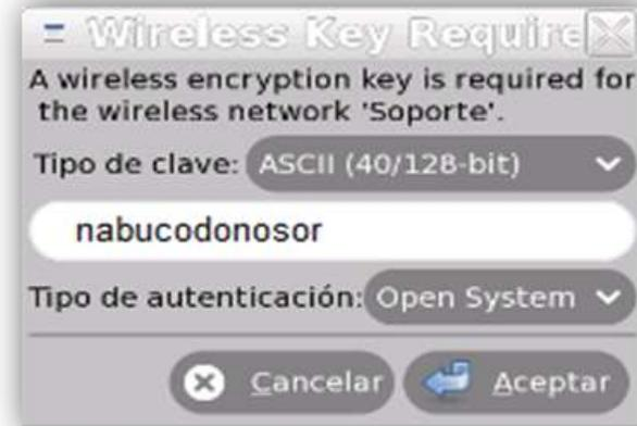
Luego aparecerá una ventana en la que se pedirá la contraseña. Para conectarse con ese AccessPoint tiene que saber la clave, el de la imagen es ASCII, que le permita colocar un máximo de 13 caracteres.
